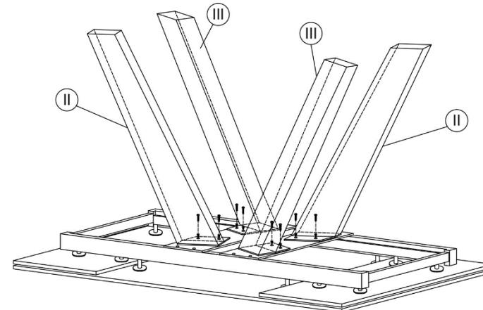
Установить ножки при помощи крепежей (винт M8x20)
